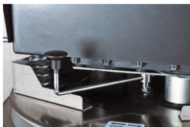
Leva inversione di flusso per la pulizia automatica del filtro. Back flow lever for automatic filter cleaning.
