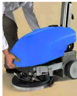
Prima di rimuovere il serbatoio soluzione è necessario scollegare l'innesto rapido
