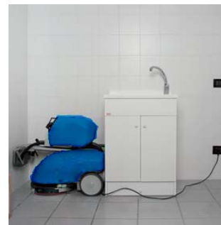
Vispa 35 presenta il carica-batterie a bordo, perciò nel momento della ricarica della macchina basta semplicemente collegare il cavo del caricabatterie ad una normalissima presa di corrente
