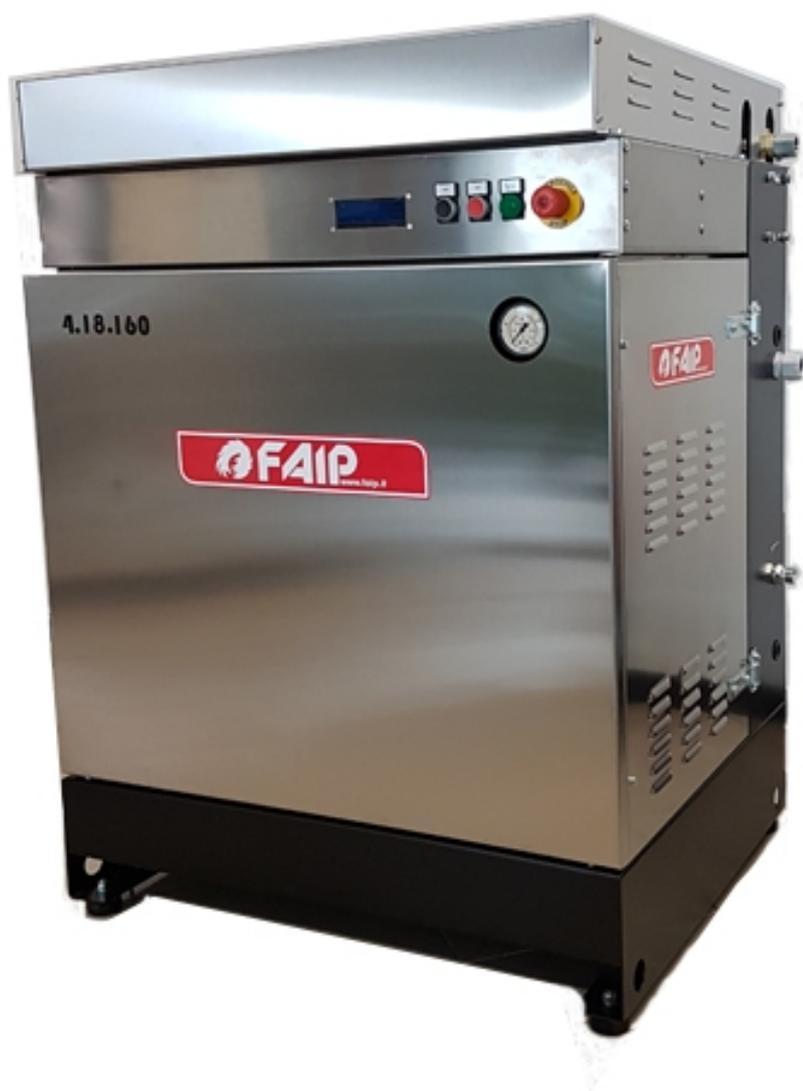
Robuste e professionali: Struttura in acciaio verniciato e pannellatura in acciaio inox con pompe a 3 pistoni in ceramica. Motori elettrici 1450 rpm ed accoppiamento pompa-motore mediante giunto elastico. Sistemi di sicurezza avanzati e sistemi antivibrazione. E' possibile tenere sotto controllo tutte le funzioni grazie al Display di verifica e controllo delle funzioni
