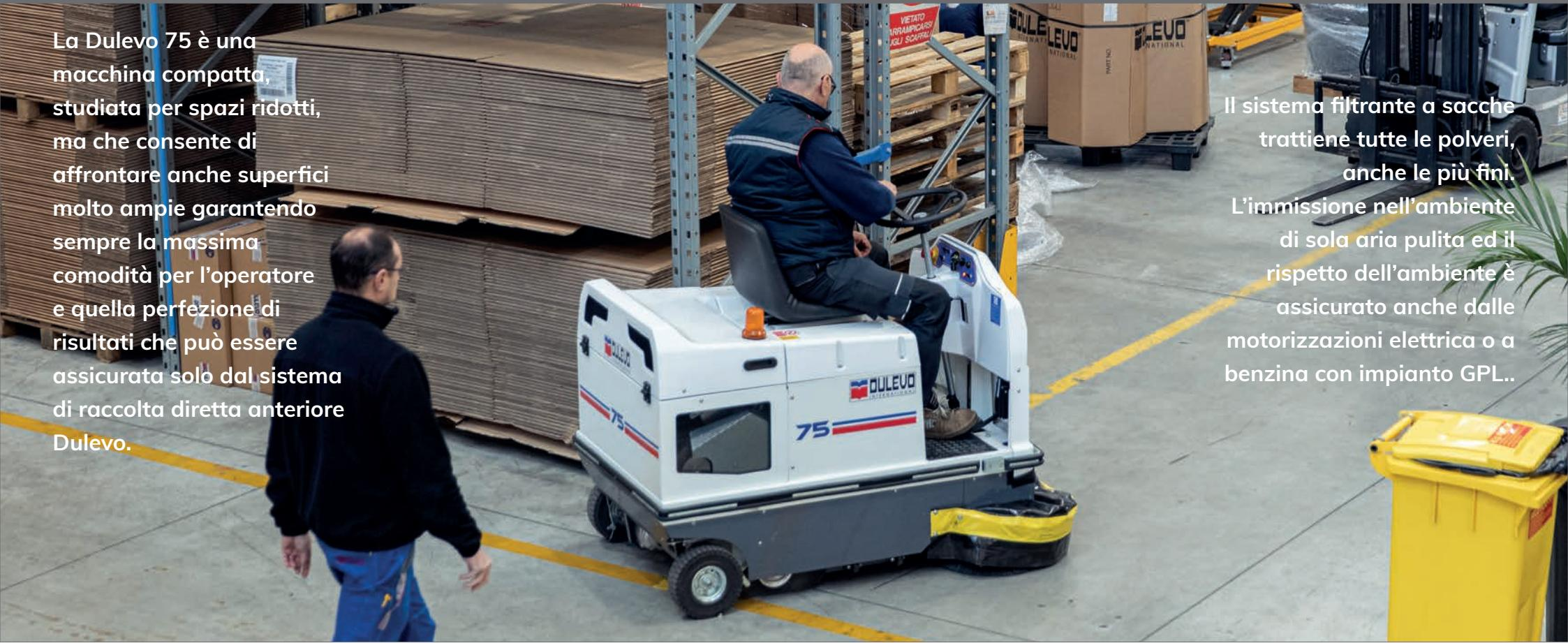
Il sistema filtrante a sacche trattiene tutte le polveri, anche le più fini. L'immissione nell'ambiente di sola aria pulita ed il rispetto dell'ambiente è assicurato anche dalle motorizzazioni elettrica o a benzina con impianto GPL..
