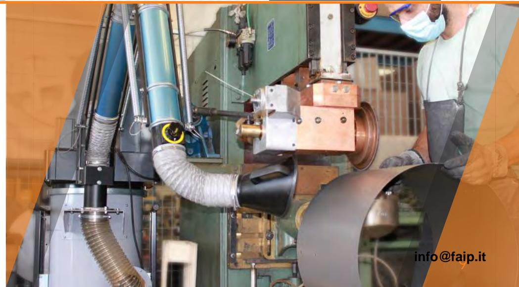
Il modello DTX 2500 BASIC è un depolveratore equipaggiato con ventilatore centrifugo da 5,5 kW e filtro in poliestere stellare. Caratterizzato da una grande portata d'aria e bassa depressione, è adatto a tutti quegli ambienti in cui è presente polvere volatile in sospensione.
