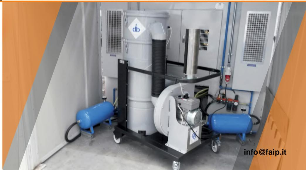
Il depolveratore DTX 1500 ICLEAN trova il suo impiego principale nella aspirazione delle polveri anche fini in sospensione. E' equipaggiato di un sistema di pulizia del filtro automatica delle cartucce che garantisce una capacità filtrante sempre efficiente, senza fermare la macchina. Ideale per rispondere alle richieste di aspirazione di polveri continue e prolungate nel tempo, particolarmente adatti nei casi di affiancamento a macchine in produzione.
