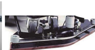
Il tergilavaggio si regola facilmente per inclinazione e pressione delle gomme ed è dotato di due ruote che servono a dare stabilità di funzionamento. Le gomme sono utilizzabili sui due lati e si possono sostituire senza bisogno di attrezzi
