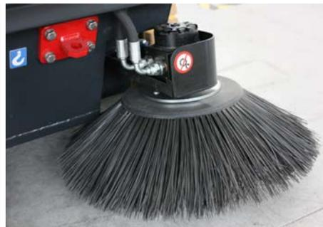
**Dulevo Boost Combi combina** l'idea di spazzamento e lavaggio allo stesso tempo. Prima di tutto, l'unità di spazzamento raccoglie i detriti, dopo di che la lavapavimenti pulisce la superficie.
